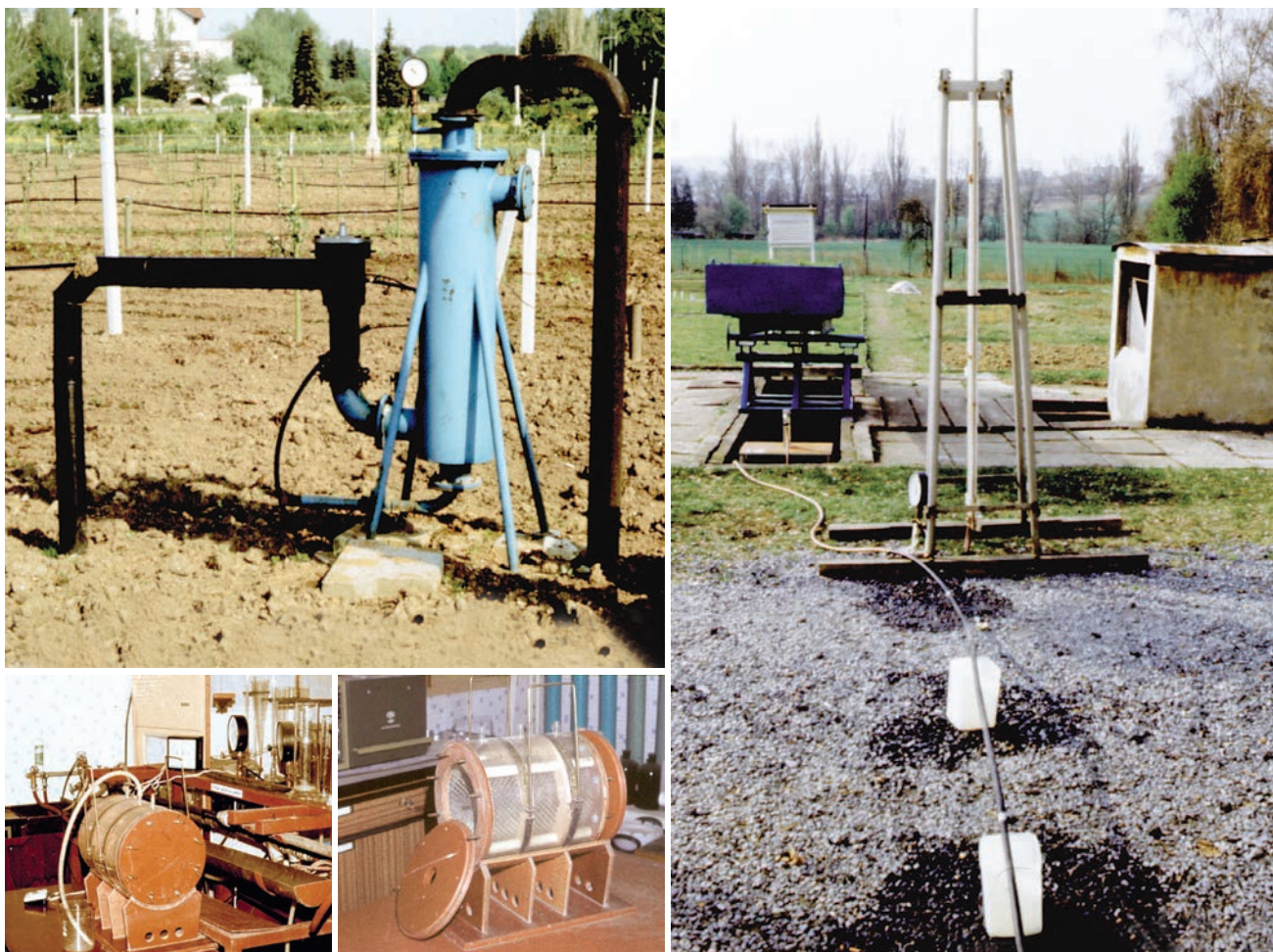
Obr. 5-19A–D Snímky z výzkumu různých zařízení pro bodové a kapkové závlahy, prováděné VUT v Brně (archiv Jana Šálka).
