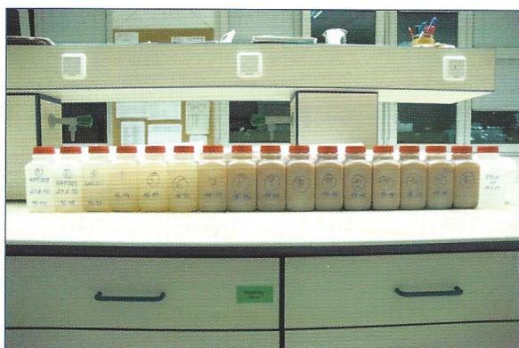
Obr. 3. Časová řada 16 vzorků erozního odtoku odebraná během dvou hodin na profilu Lhotecký potok dne 21. 6. 2007 (foto: Daniel Fiala)
