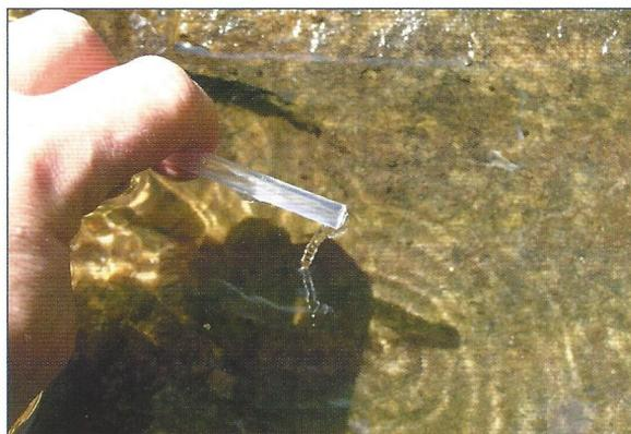
**Obr. 2.** Na konci zařízení lze přímo změřit průtok, odebrat vzorek vody prošle odběrákem nebo změřit rozdíl pracovních hladin
