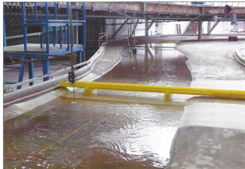
Obr. 3. Příklad umístění měřicího zařízení při modelovém výzkumu týkajícím se ochrany mostních objektů při povodňových událostech
