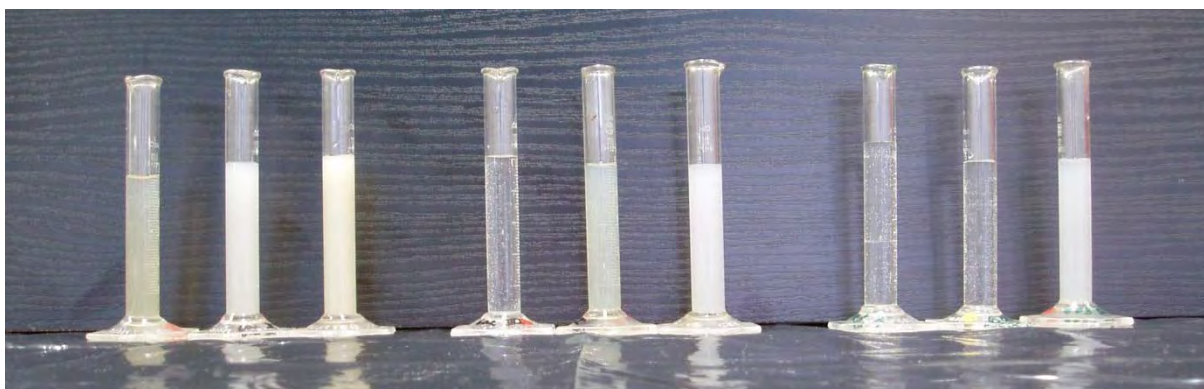
Obr. 3.4.1 Výsledky různé intenzity extrakce semipermeabilních membrán pomocí acetonu
