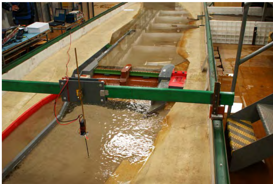
Obr. 1.1.3 Simulování výpadku vodní elektrárny Plavební stupně České Vrbné ČVUT Praha fakulta stavební
