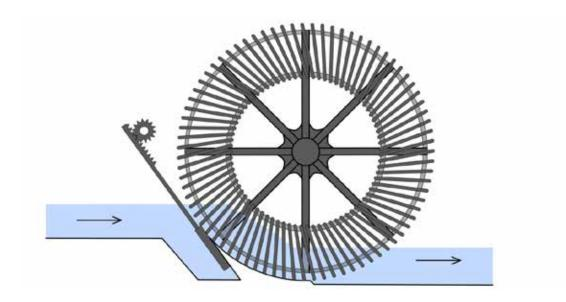
Fig. 4.195: Sagebien water wheel. Diagram by Radka Račoch and Michaela Mrvová, 2021 (modified according to Hýbl 1922; Štěpán et al. 2008; Štěpán, 1990; Digitalisierung des Polytechnischen Journals, 2021).
