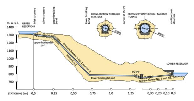
Fig. 4.209: Dlouhé stráně PSHPP – a hydraulic circuit diagram. Diagram by Radka Račoch and Michaela Mrvová, 2021 (modified according to: Kopřiva et al., 1997).
