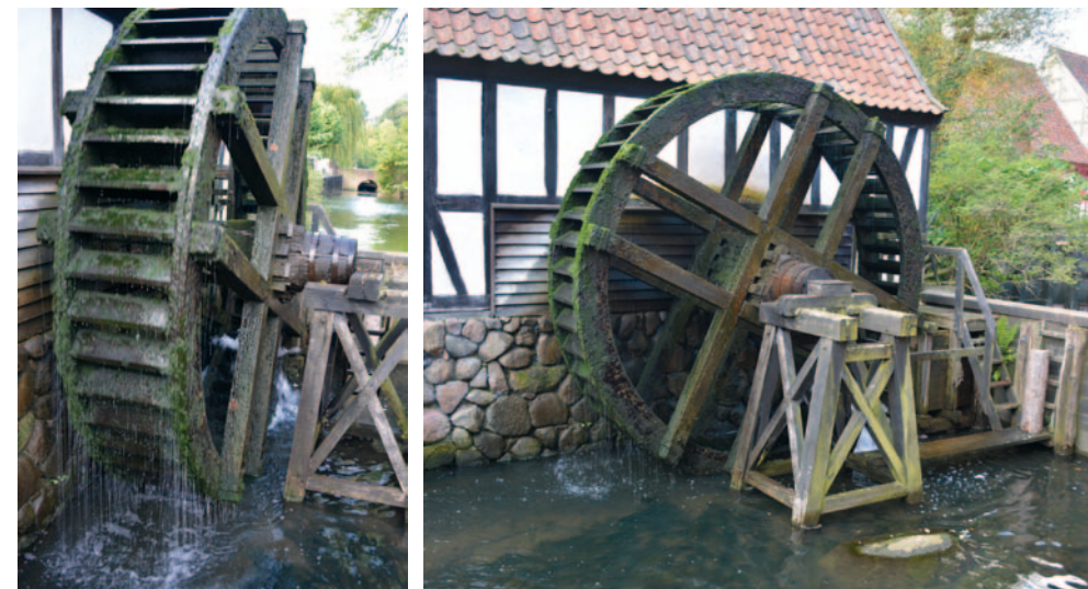
Obr. 4.168: Aarhus (Dánsko), muzeum v přírodě Den Gamle By – vodní kolo na spodní vodu s neúplnými korečkami typu vlk. Foto Radim Urbánek, 2015.
