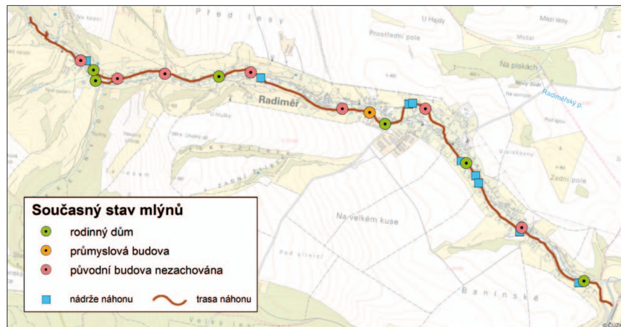
Obr. 3.5: Systém Radiměřského náhonu se 14 mlýny a 9 malými vodními nádržemi – současný stav (trasa náhonu se částečně zachovala jako relikt v terénu); příklad širší soustavy technologického celku, který se skládá z tělesa náhonu, včetně ovládacích proků (stavidla, nátoky na vodní kola), malých vodních nádrží pro zvýšení akumulace vody v náhonu, vodních kol (nedochovaných) se systémoovou vazbou na technologie vodních mlýnů, které samy o sobě představují ucelenou fázi technologického toku. Schéma David Honek, 2020.
