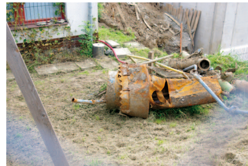
Obr. 5.28: Vstrojení dosazovací nádrže ČOV poškozené při rekonstrukci čistírny. Foto Miloš Rozkošný, 2021.
