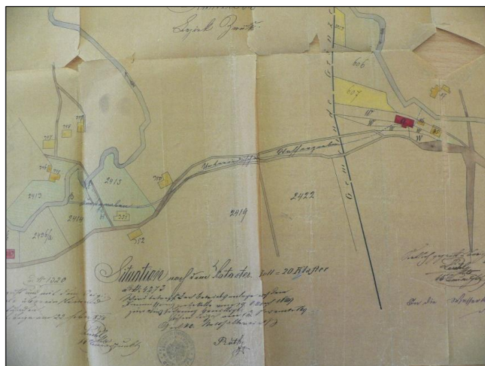
Obr. 4.5 Situační plán vodního díla brusírny a leštírny zrcadel č. p. 66 z roku 1869. Zrcadlárna je vyobrazena červeně v pravé části, čárkovaně je před ní vykreslen náhon, skrytý pod terénem. (zdroj: SOKA Česká Lípa, OÚ Česká Lípa, kart. 85)
