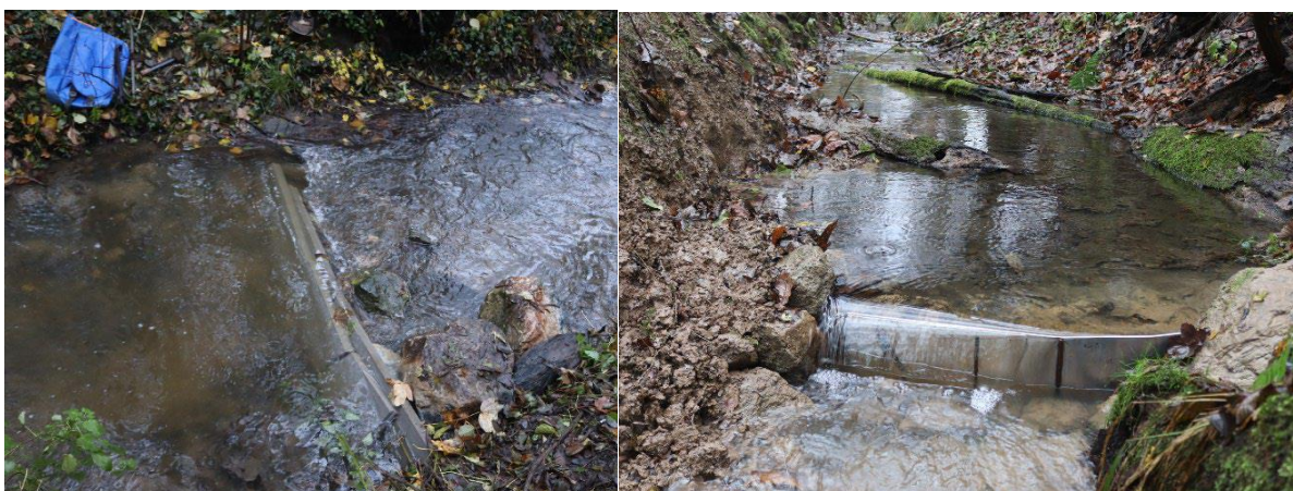
Obr. 1. Sledované objekty s automatickým měřením výšky hladiny nad přelivem a manuálním měřením průtoku.
