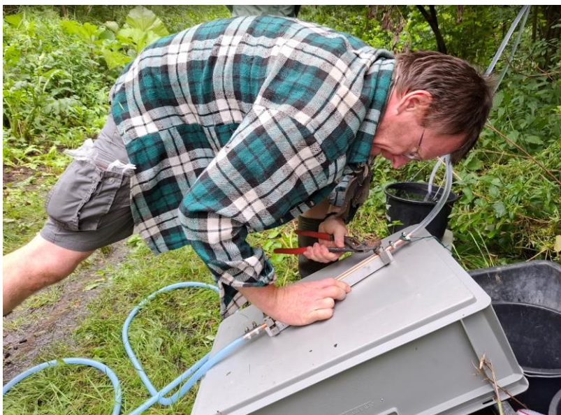
Obr. 2. Odběr vzorků pro analýzu vzácných plynů (Kovánecký pramen).
