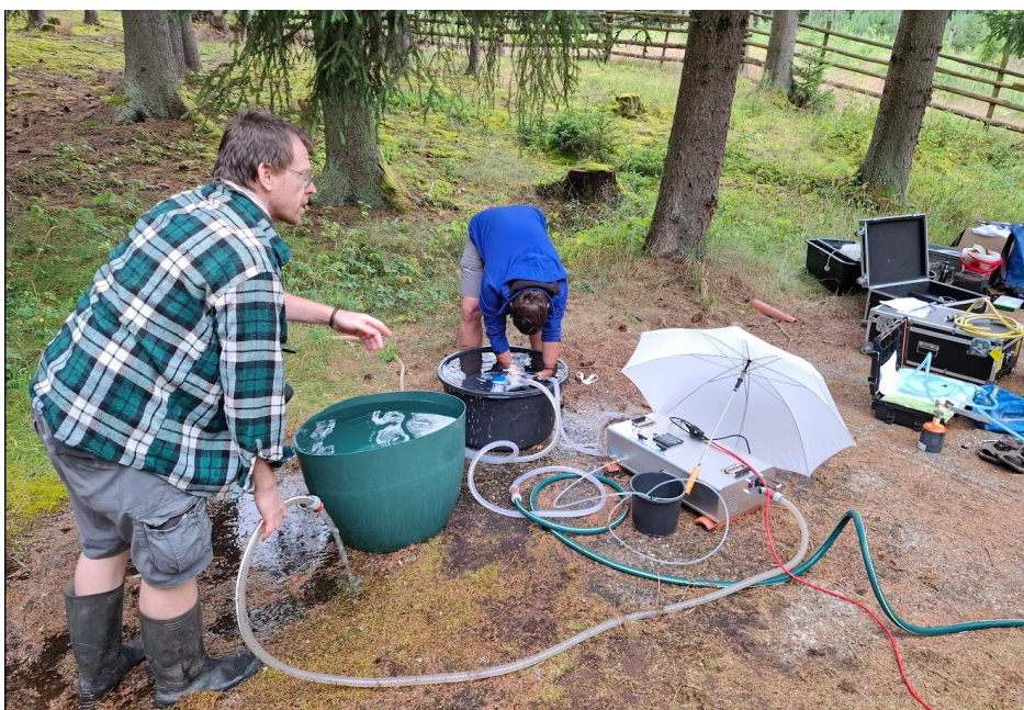
Obr. 3. Odběr vzorků pro analýzu ^{39}\text{Ar} , ^{85}\text{Kr} (vrt KL7).
