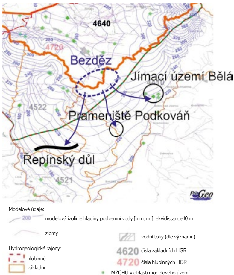
Obr. 11. Modelové izolinie hladiny podzemní vody modelu společnosti PROGEO, s. r. o., s vyznačením pravděpodobného místa infiltrace nízkotritiových vod (modrý ovál) a směrem proudění (modré šipky). Upraveno dle [1]
