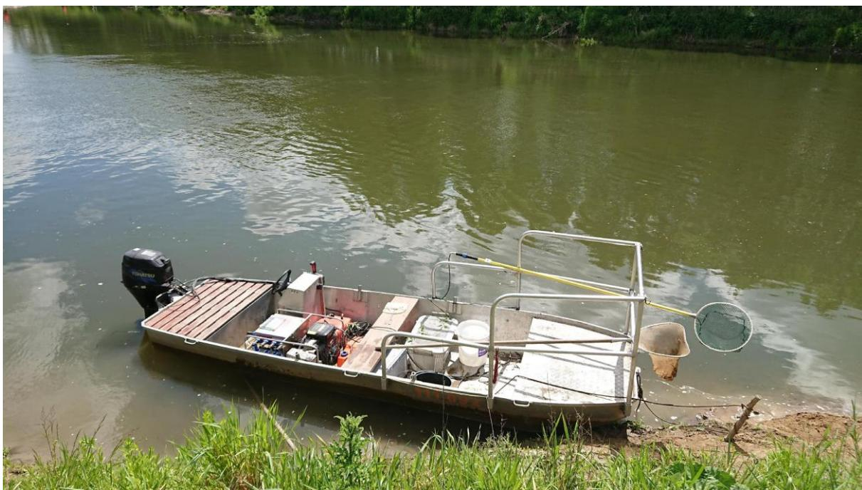
Obr. 18. Elektrolovná loď s výkonným hlubinným agregátem
