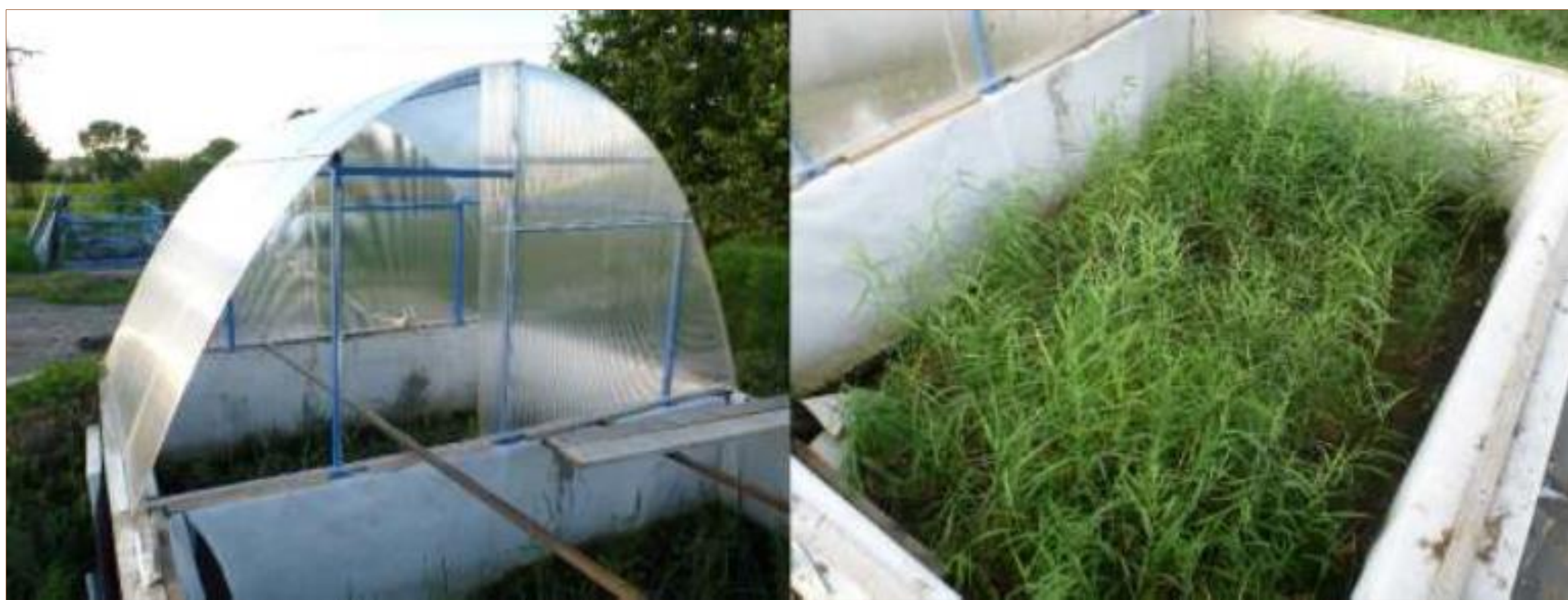
Pokusné „reed bed“ systémy v areálu ČOV Dražovice
