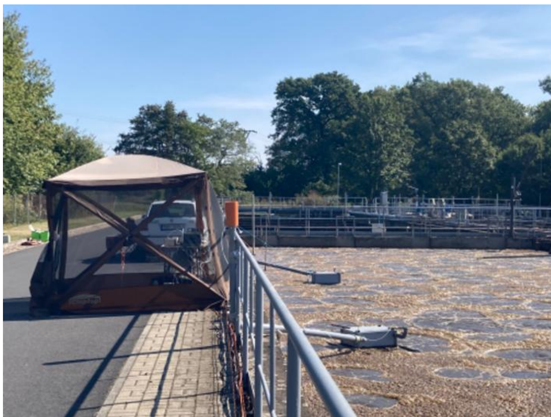
Obrázek 25: Měřicí komory na hladině aktivační nádrže
