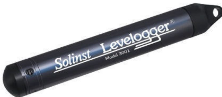
Obrázek 3: Použitá hladinoměrná sonda Solinst (www.solinst.com)
