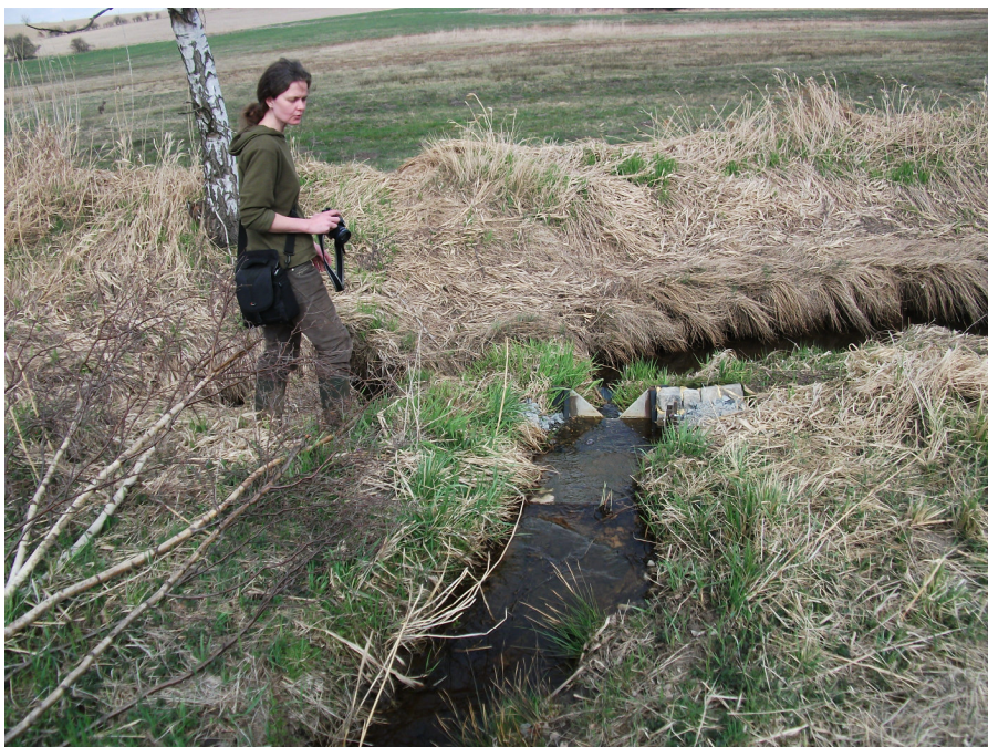
Chvojnov – celkový pohled na profil „Vodočet“ s měrným přepadem do potoka
