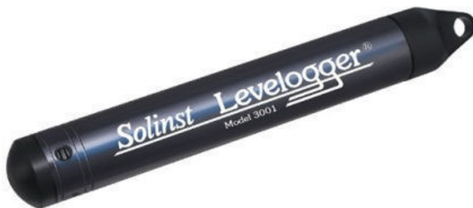
Obrázek 3: Použitá hladinoměrná sonda Solinst ( www.solinst.com )
