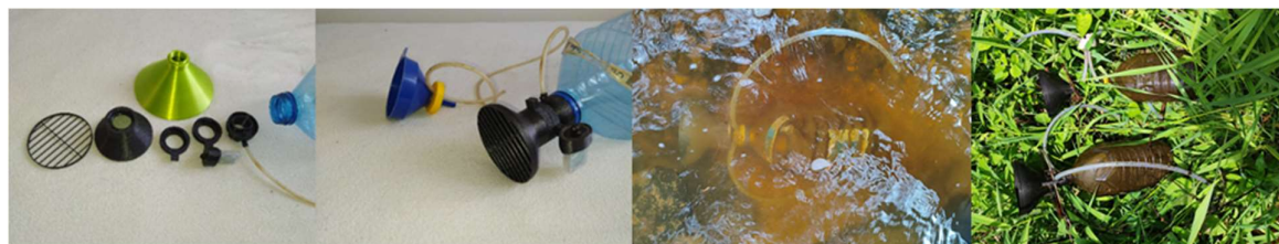
Obr. 37: Prototypy pasivních odběráků a jejich testování. Na prvním obrázku jsou vidět jednotlivé součásti, které lze dle potřeby přidat/odebrat, případně vyměnit, na druhém obrázku je pohled na složené nové odběrové zařízení. Třetí a čtvrtý obrázek ilustrují umístění v toku, respektive stav po vyjmutí.
