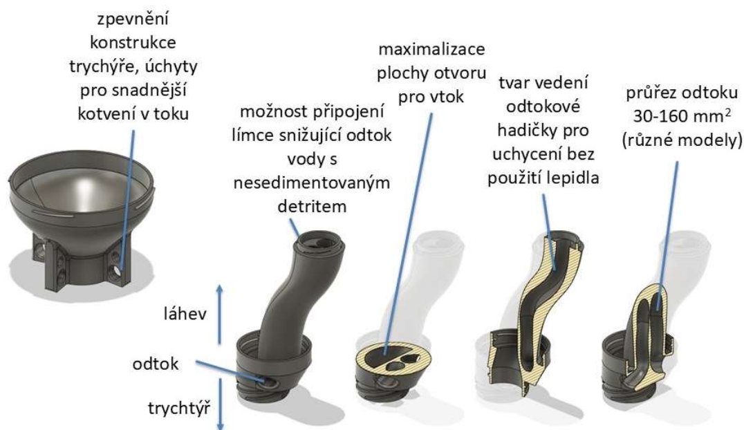
Obr. 35: Vývoj odběrového zařízení detritu. Vlevo – model vtokového trychtýře (průměr 12 cm, výška 10 cm); vpravo – model nástavce na sběrnou lahev a jeho řezy. Nádkresy byly vytvořeny v programu Autodesk Fusion Personal.
