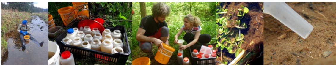
Obr. 2: Vzorkování detritu z toků přímým odběrem ze dna toku, jeho sedimentace a slévání zahuštěných vzorků.
