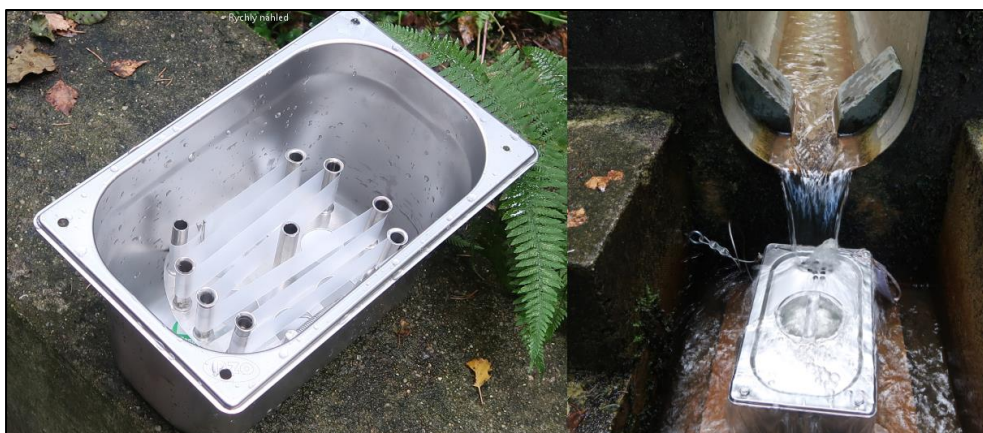
Obr. 4.18. Pasivní vzorkovač SR (Silicone Rubber) v nerezové nádobě, povodí Lesního potoka
