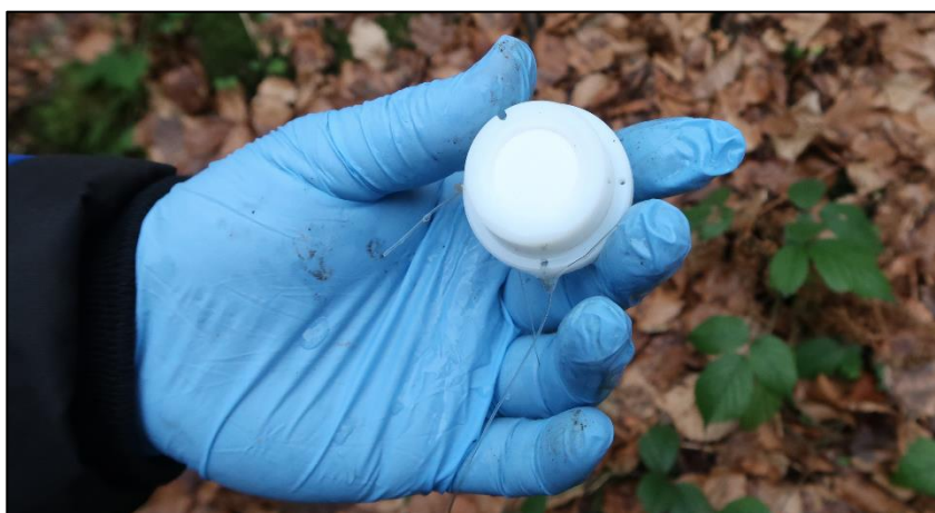
Obr. 4.16. Pasivní vzorkovač DGT (Diffusive Gradients in Thin-films)
