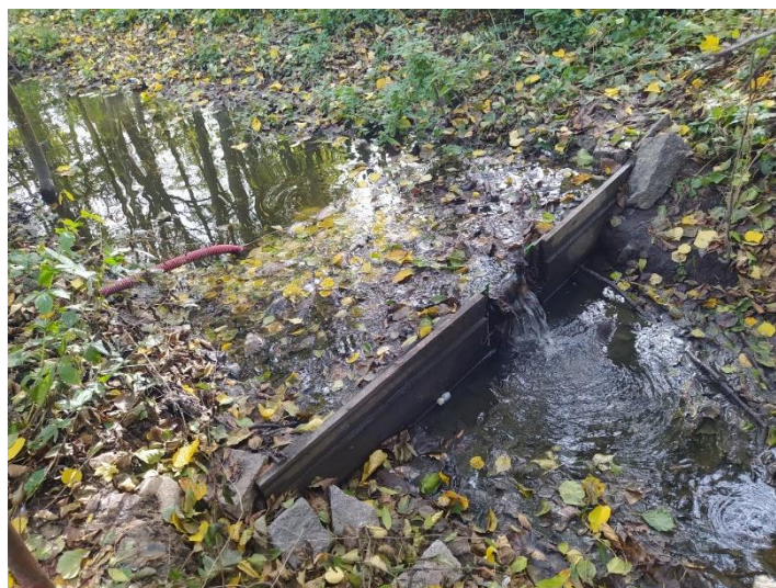
Obr. 6.11 - Vodoměrný profil s online záznamovým zařízením na odtoku z Nesvačilského rybníka – podzim 2023
