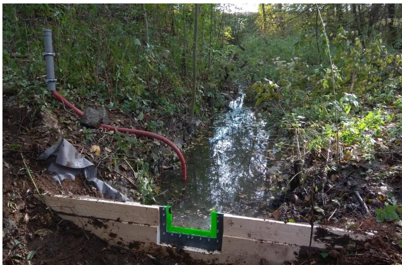
Obr. 6.9 - Vodoměrný profil s online záznamovým zařízením na odtoku z Nesvačilského rybníka – podzim 2021
