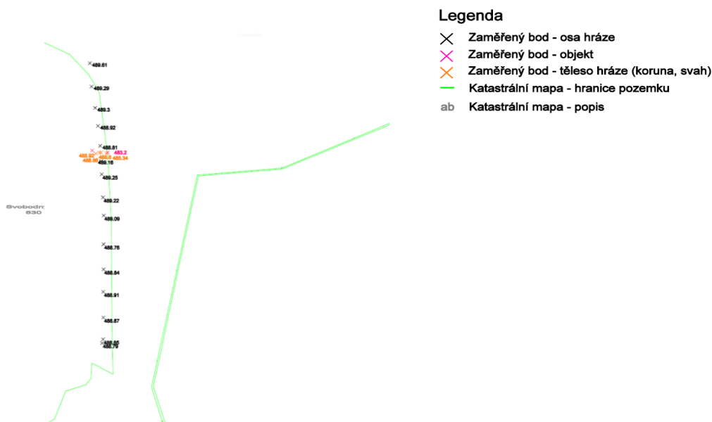
Obr. 5.5 – Katastrální mapa s geodetickým zaměřením lokality Svobodný rybník
