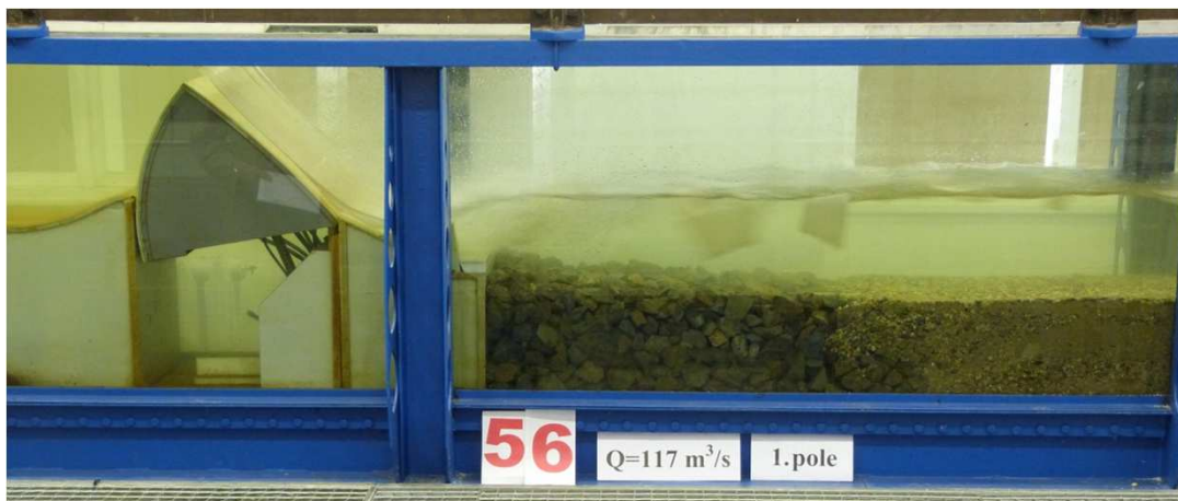
Transport ledů při průtoku Q = 117 \text{ m}^3 \cdot \text{s}^{-1} jedním jezovým polem
