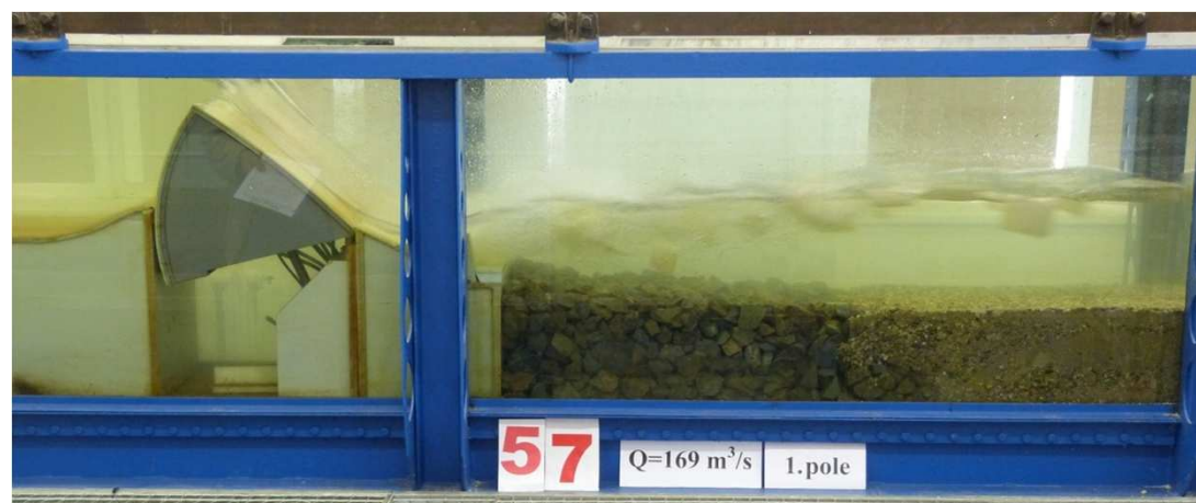
Transport ledů při průtoku Q = 169 \text{ m}^3 \cdot \text{s}^{-1} jedním jezovým polem
