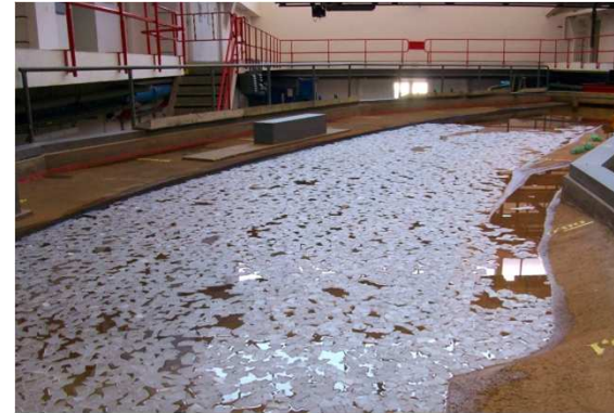
Obr. 2 - Zdrž naplněná ledovými krami
