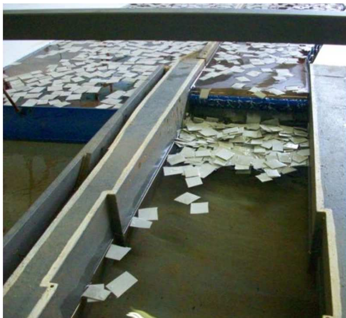
Hromadění ledů pod horním ohlavím plavební komory při průtoku 117 m 3 /s
