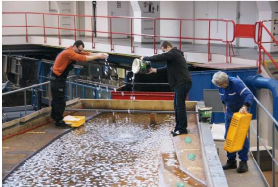
Obr. 1 - Sypaní ledových ker do modelu
