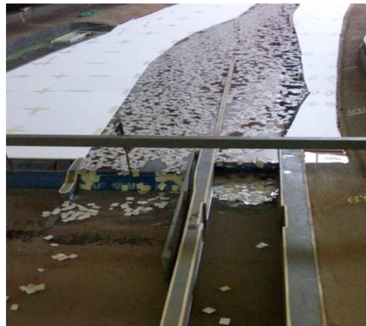
Hromadění ledů pod horním ohlavím plavební komory při průtoku 248 m 3 /s
