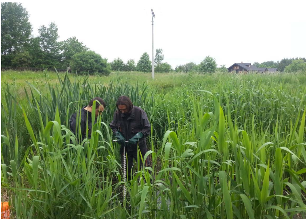
Odběr vzorku kameniva kolmatované přítokové zóny kořenové čistírny
