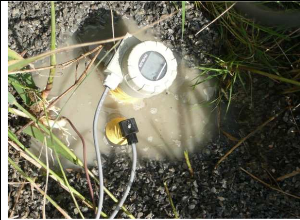
Osazení terénních elektrod pro kontinuální záznam teploty vody, elektrické konduktivity a koncentrace kyslíku
