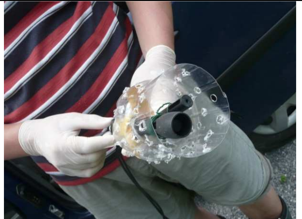
Osazení terénních elektrod pro kontinuální záznam teploty vody, elektrické konduktivity a koncentrace kyslíku
