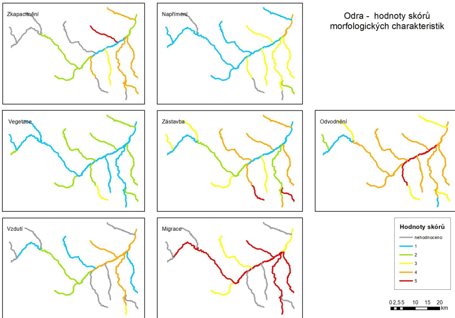
Obr. 12: Mapové znázornění hodnoty skóre pro morfologické charakteristiky vodních útvarů v pilotním povodí Odry
