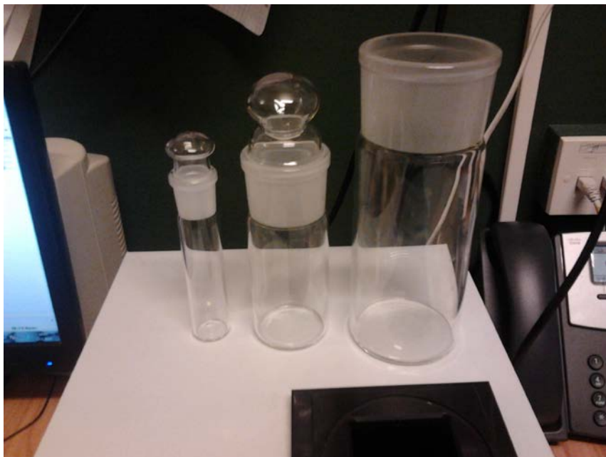
Vzorkovnice kruhového průřezu z borosilikátového skla se zábrusovým uzávěrem
