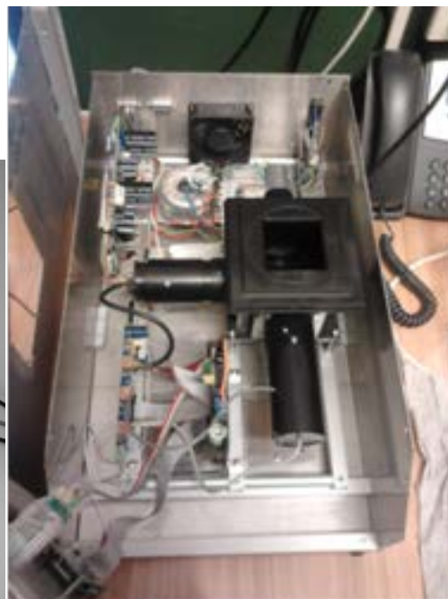
AOC turbidimetr – celkový pohled (vlevo) a) pohled dovnitř (vpravo)
